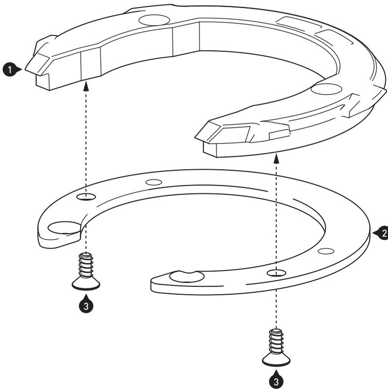
Verschrauben Sie den Tankring (1) mit dem Montagering (2). Ziehen Sie die Schrauben (3) vorsichtig an.
