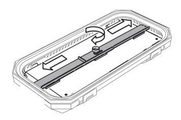
Bitte achten Sie beim Einsetzen der Verklemmschienen auf deren mittigen Sitz im Kofferdeckel. Überprüfen Sie nach dem Festziehen der Rändelschraube (4) den festen Sitz aller Komponenten im Kofferdeckel.
